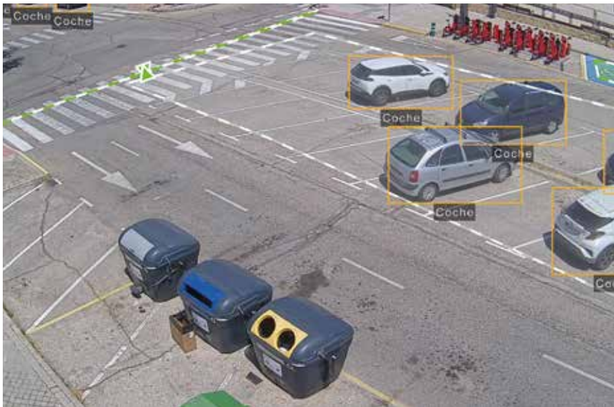
Captura de la cámara que monitorea el control de plazas en el aparcamiento del polideportivo del Parque del Sureste. Así, se podrán ver las plazas disponibles antes de llegar.
